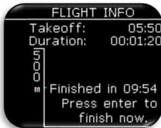
Se il pilota non interviene, dopo l'atterraggio il registratore di volo inizierà il conto alla rovescia 10 minuti prima che il volo venga terminato in modo automatico. Dopo 10 secondi all'inizio del conto alla rovescia verrà mostrata automaticamente questa pagina per avvisare il pilota che il volo sarà concluso dopo 10 minuti. Il pilota può aspettare fino alla conclusione del conto alla rovescia o premere Invio per terminare immediatamente il volo.
