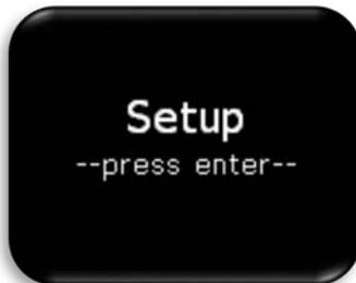
Selezionata la pagina Setup con il selettore rotativo, per entrare nelle opzioni di configurazione, premere invio. Tutte le opzioni di setup verranno visualizzati in un elenco. Utilizzare selettore rotativo per selezionare la voce di interesse.
