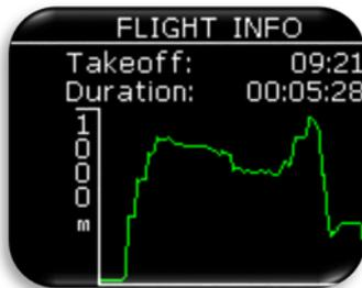
Durante il volo, le statistiche del volo sono riportate nella pagina statistiche. Sulla parte superiore sono visualizzate l'orario di decollo (Take-off) e il tempo trascorso fino a quel momento, mentre nella parte inferiore è rappresentato il diagramma barografico delle quote dell'ultima ora di volo.
