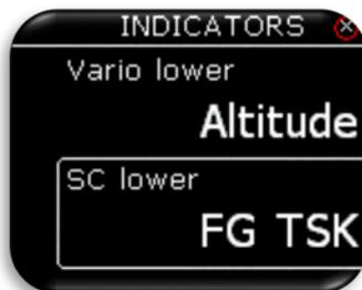
**Vario lower** e **SC lower:** sono l'indicazione inferiore del display numerico in modalità Vario o SC vario nella pagina vario. Le scelte possibili sono:
